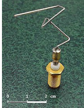
Рисунок 4 — Антенна, спроектированная генетическим алгоритмом
